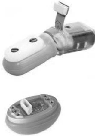
**Figura 2.7:** Sensor Biotac desenvolvido pela SynTouch [14].
