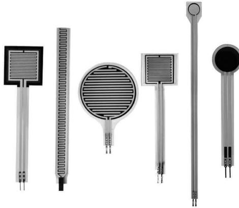
**Figura 2.12:** Sensores FSR desenvolvidos pela Interlink [26].
