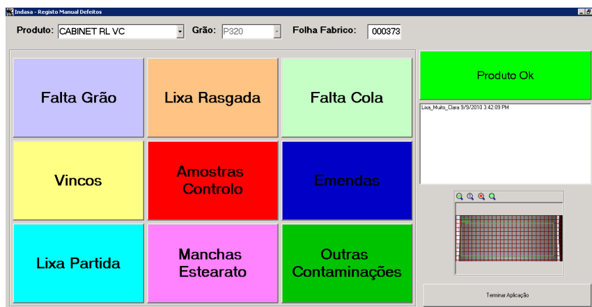
Figura 52 - Interface gráfica da aplicação para recolha de resultados do sistema
