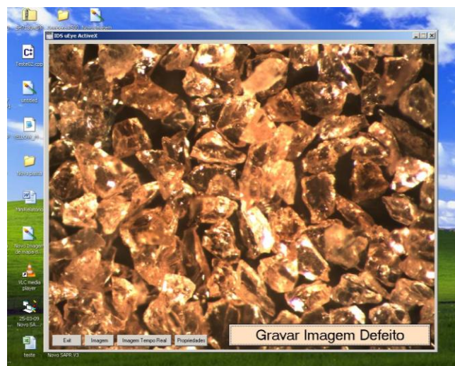
Figura 36 – Interface gráfica da aplicação de registo manual de imagens
