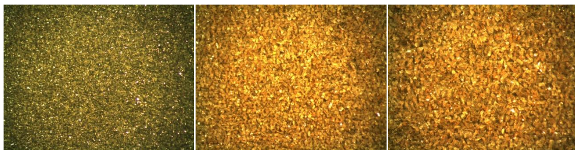
Figura 62 - Imagens ampliadas abrasivo flexível tipo A: P500, P180 e P150
