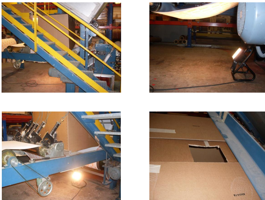
Figura 34 – Montagem provisória de ensaios da retro iluminação
