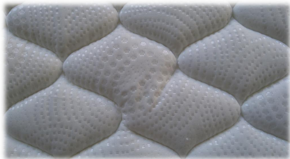
Figura 1 - Amostra de colchão analisada, onde se observa um defeito na costura.
