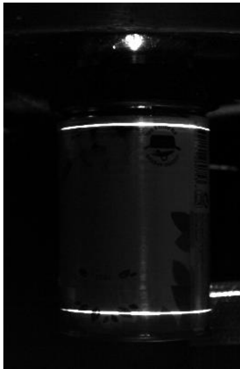
Figura 1 - Captura das linhas laser projetadas na lata.
