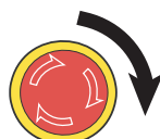
Fig. 1-4: Habilitação do botão de paragem de emergência
