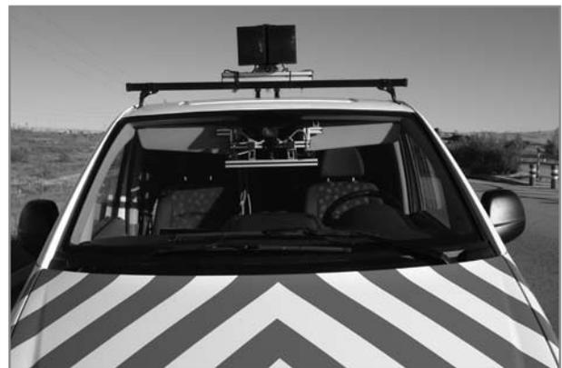
Foto 4. El equipo de auscultación *Visualise* supone un salto cualitativo y cuantitativo en la evaluación del nivel de servicio de la señalización vertical.
