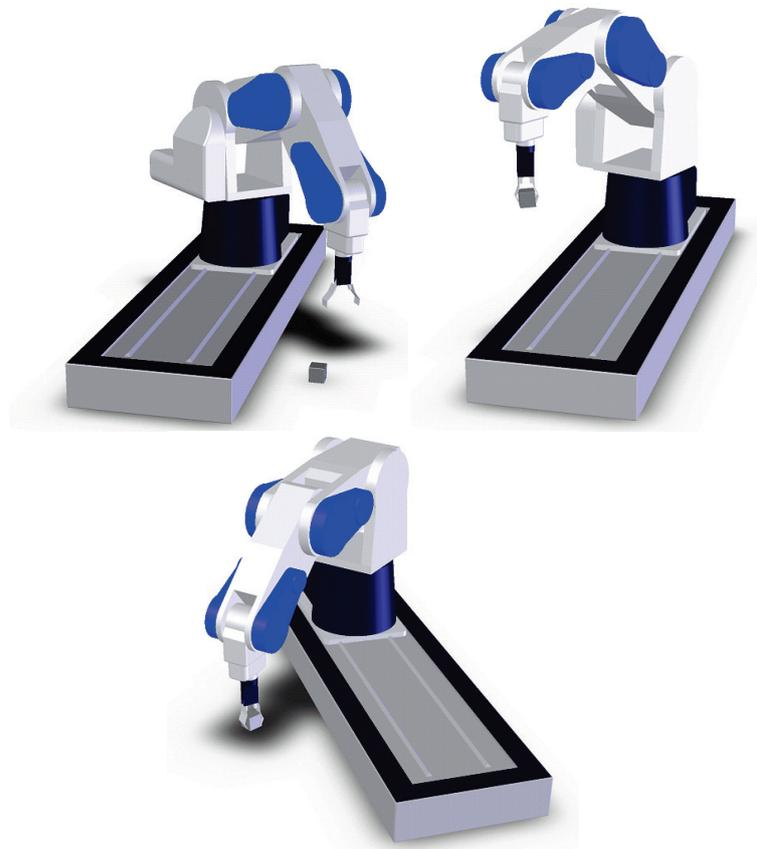
2 – Colocação da *Webcam* numa determinada posição fixa e, depois de calibrada, obter a localização de um objecto de geometria simples (o mesmo cubo) para fazer a transferência para outra área a definir, por exemplo o outro lado do eixo linear.
